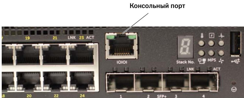
Рисунок 1-9. Консольный порт на передней панели N1524P
